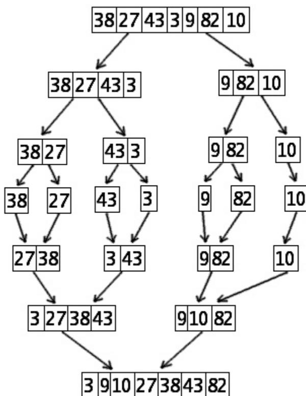
Exemple de tri par fusion appliqué à un tableau de sept éléments (source : Wikipédia)
